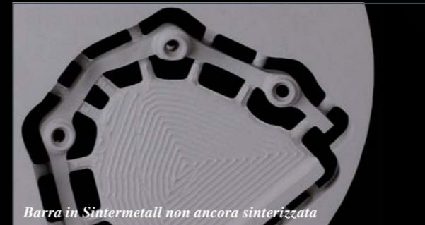
*Barra in Sintermetall non ancora sinterizzata*
