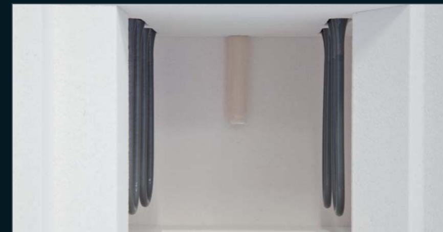
Camera di sinterizzazione del forno Zirkonofen 700 con resistenze MoSi<sub>2</sub>
